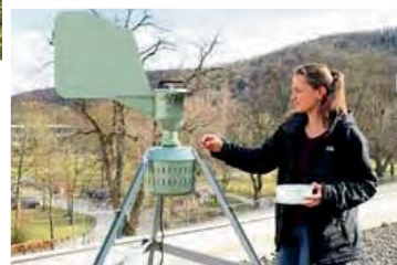
Foto 14, links: Das Projekt beschäftigt sich mit dem allergenen Potential von Parkanlagen. (J. Jeltsch) Foto 15, unten: Zur Bestimmung der Pollenkonzentration werden volumetrische Pollenfallen eingesetzt. (S. Jochner-Oette)
